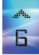
Màn hình tinh thể lỏng 4.3 inch (dùng cho bảng hiển thị tầng)
